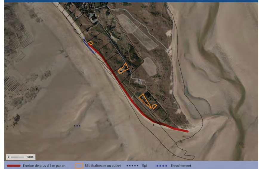
5 : enjeux menacés : bâti diifus, voirie.
